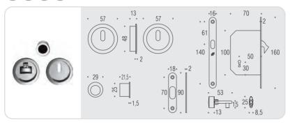
Kit per porta scorrevole composto da due maniglie ad incasso con dispositivo di chiusura con chiave, maniglietta di trascinamento e serratura (E 50mm) a gancio dotata di contropiastra in acciaio inox. Sliding Doors Kit composed of two groove handles with key, flush handle and stainless-steel mortise hook lock (E 50mm) with striking plate.
