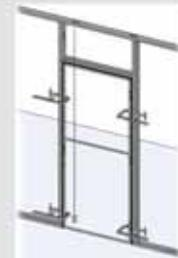
Материал и толщина дверной коробки должна выдерживать петлю и делать ее стабильной в момент открывания/закрывания дверного полотна.
